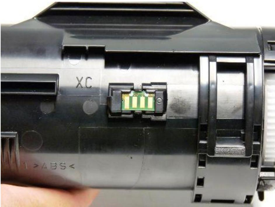
Протрите картридж, чтобы очистить остатки тонера. Проверьте на утечки на порте тонера. Если таковые имеются, возможно, не полностью заблокирована крышка.
