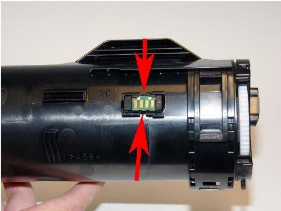
Замените чип, освободив два выступа на держателе чипа, сдвиньте держатель, чтобы снять его. Снимите старый чип, нажав на две вкладки, и замените его на новый. Вставьте чип и держатель на место.
