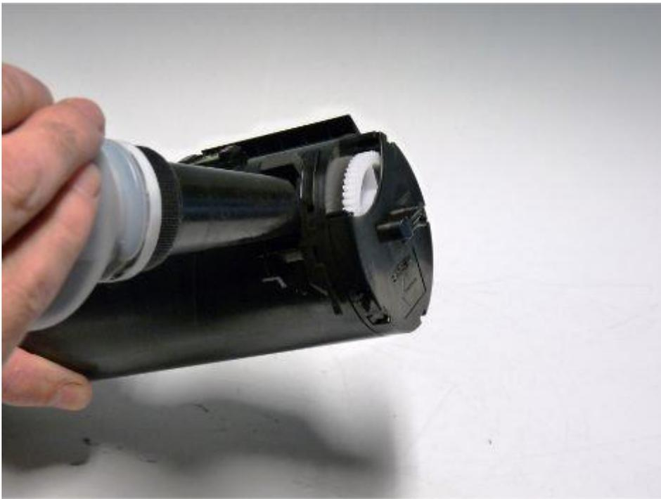
Установите крышку порта тонера и сдвиньте ее, чтобы закрыть.
