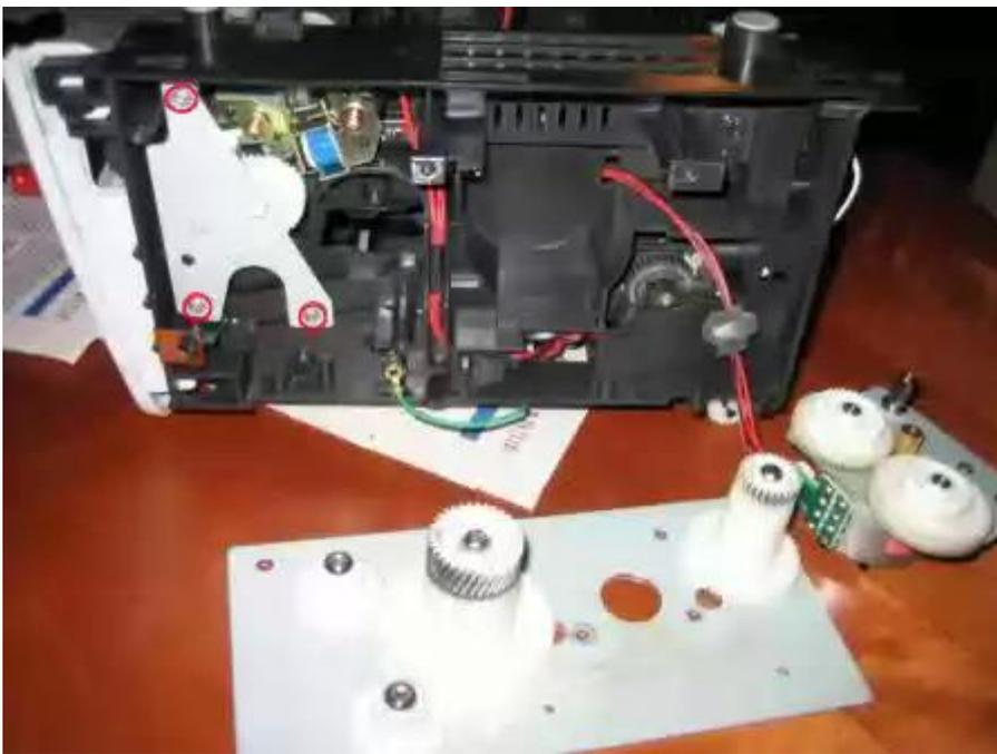
Теперь нам нужна шестеренка, которая сидит на основании и к которой крепится ролик захвата бумаги. Снимаем, разжав защелки.
