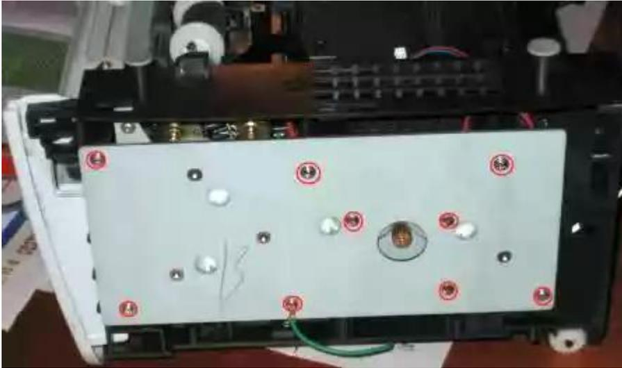
Не снимая шестеренок, отсоединяем железную пластину (еще три шурупа).
