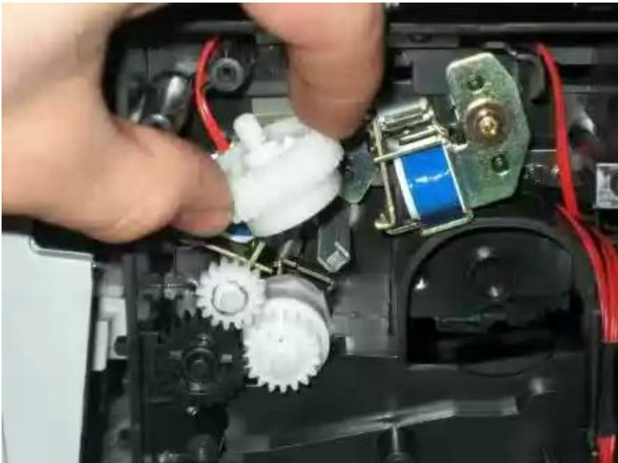
Устраняем последнее препятствие, мешающее разлучить основание с роликом захвата бумаги и принтер: приподнимаем защелку и сдвигаем пластмассовую деталь в сторону.
