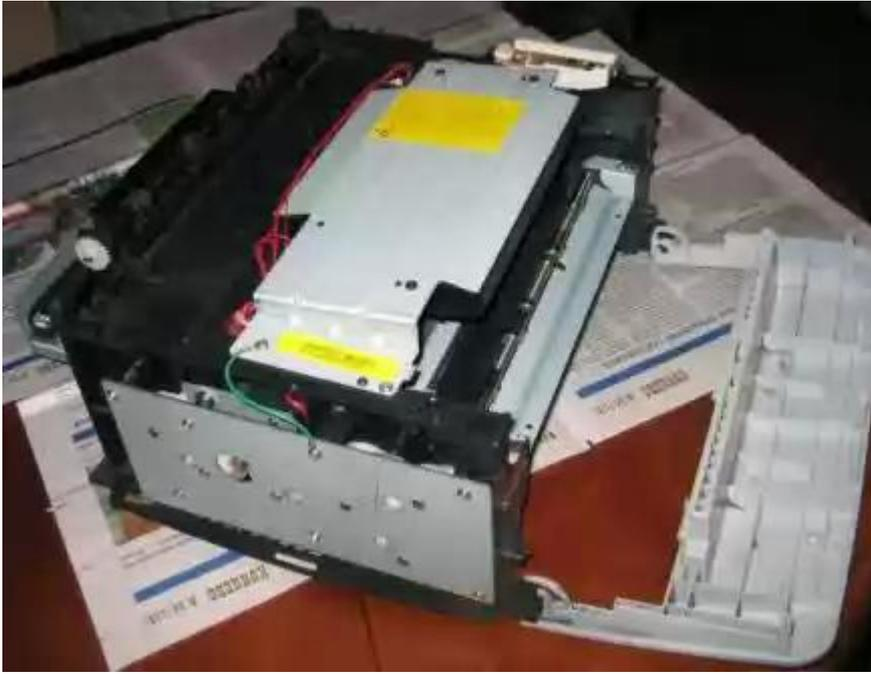
Избавляемся от проводов сзади, еще два шурупа - долой.
