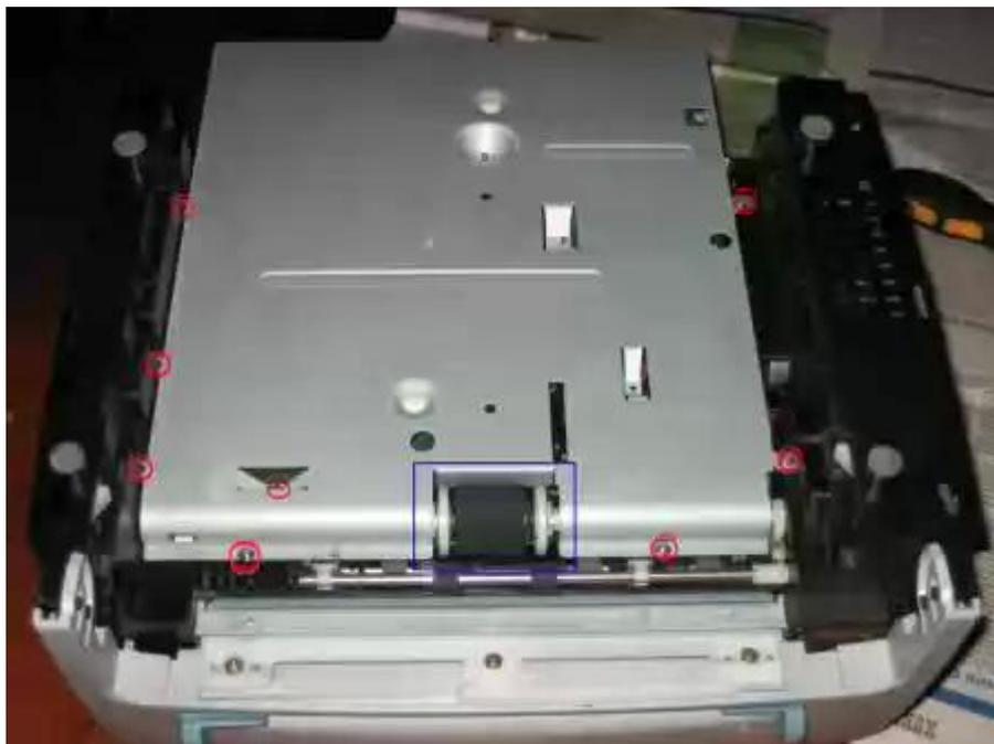
Аккуратно приподнимаем нижнюю часть принтера (со стороны вентилятора), избавляемся от последних пяти проводов (лишая тем самым нижнюю часть принтера законного основания).
