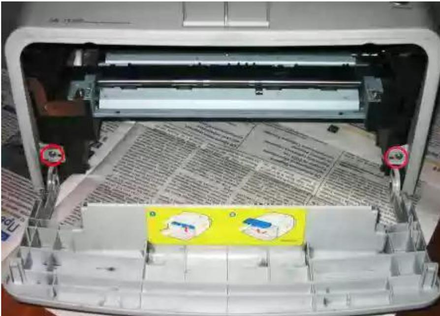
Отделяем корпус от основания: откручиваем два шурупа, тянем корпус за края вверх.
