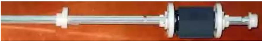
Снимаем ролик захвата бумаги: отщелкиваем один из его ограничителей.
