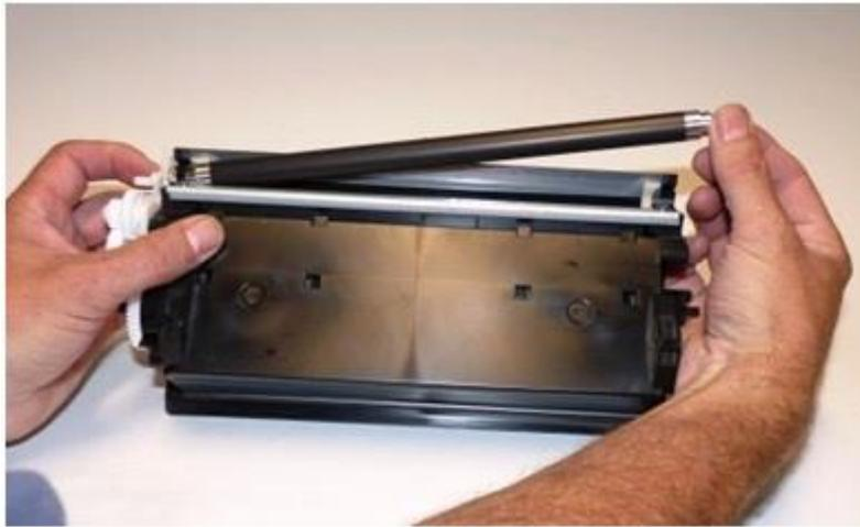
28) Выкрутите два винта из дозирующего лезвия. Оба винта имеют нормальные правые резьбы. Поднимите лезвие, убедитесь, что липкое уплотнение остается на картридже. См. Рисунок 43
