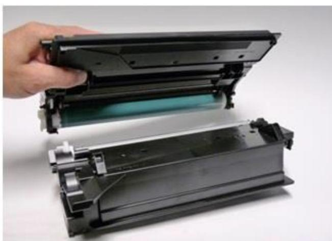
5) В бункере отработанного тонера снимите винт с торцевой крышки барабана. Вырежьте пластик, как показано на рисунке, и снимите торцевую крышку. Торцевая крышка прикреплена в одном месте. См. Рисунки 10, 11, 12 и 13
