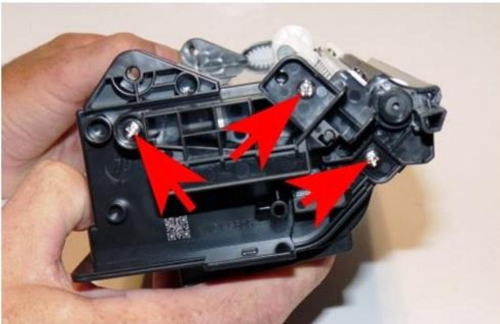
23) Снимите торцевую крышку. См. Рисунок 36
