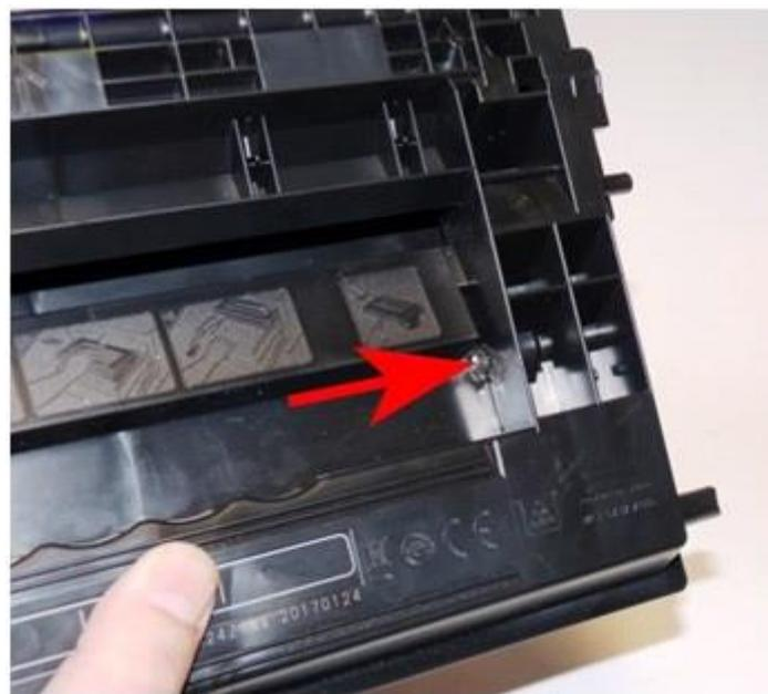
3) С помощью модифицированного крюка зубного щупа вставьте изогнутую сторону в просверленное отверстие и вытащите штифты с каждой стороны. Вам может понадобиться небольшой штырь и молоток, чтобы выбить их. См. Рисунки 7 и 8.
