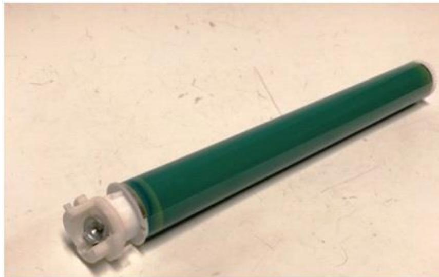
7) Достаньте вал первичного заряда. Обратите внимание на токопроводящую смазку с одной стороны. См. Рис. 16 и 17. Помойте вал изопропиловым спиртом
