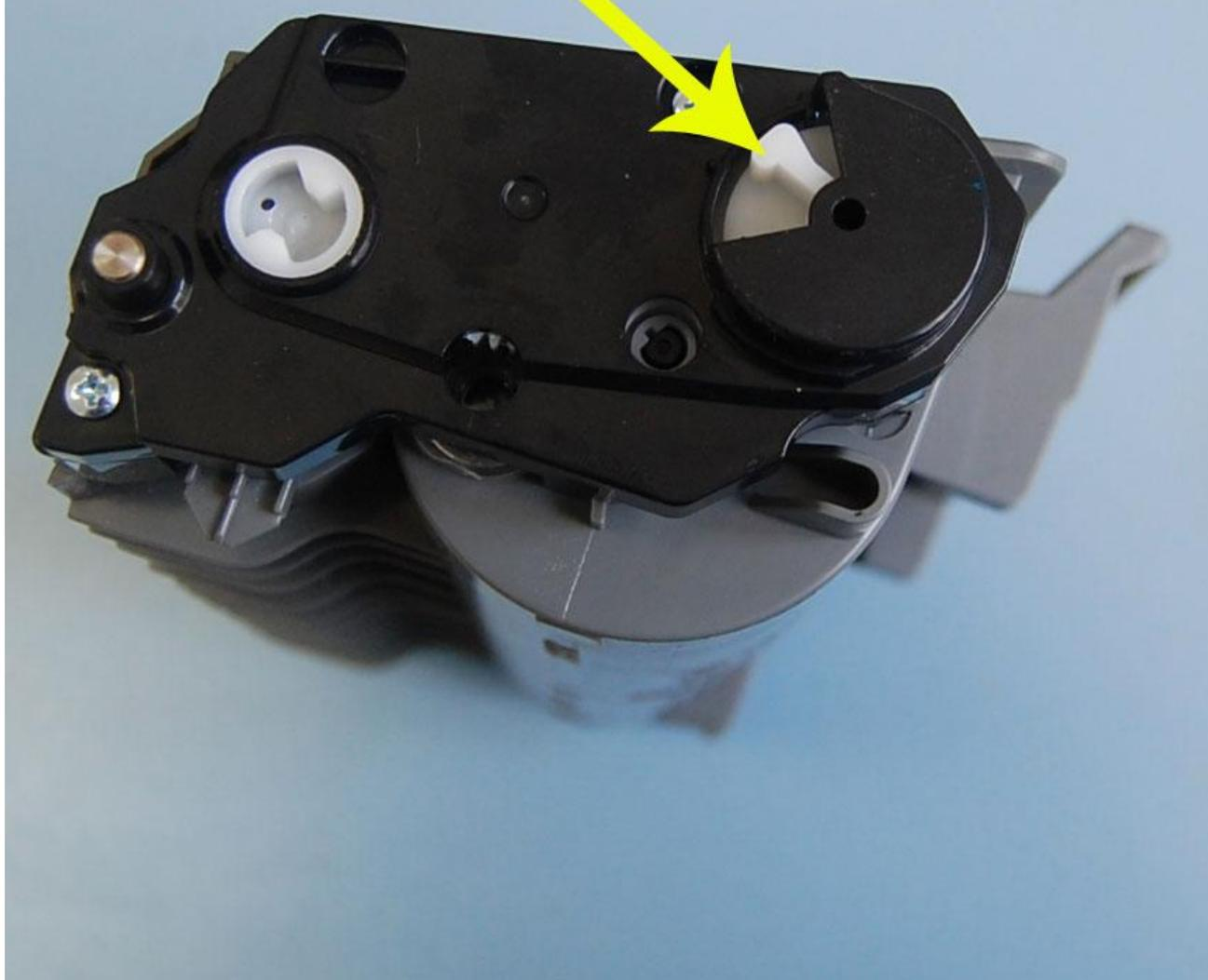
Далее с другого бока картриджа открываем пробку и засыпаем тонер. Для заправки можно использовать тонер для картриджей Brother TN-3130/3170 или использовать универсальные тонеры Brother. Картридж отличается надежностью и неприхотливостью к тонеру. Обратите внимание, аппарат определяет наличие тонера с помощью оптического датчика на просвет. Если просто взвести
