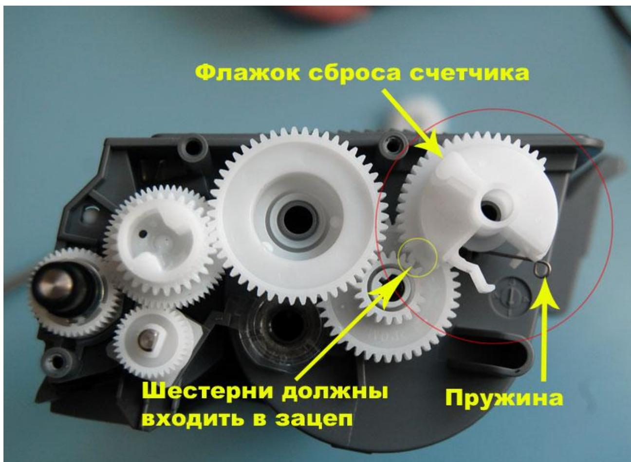
Заправлять эти картриджи одно удовольствие, конструкция примитивна. Пожалуй, самое сложное во все процедуре заправки картриджа, это установка флажка сброса счетчика тонера в
