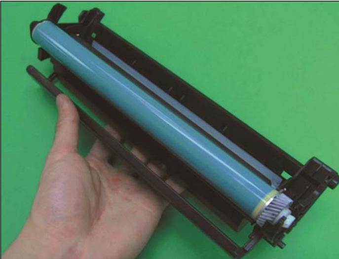
**INSTALLING THE OPC DRUM**
