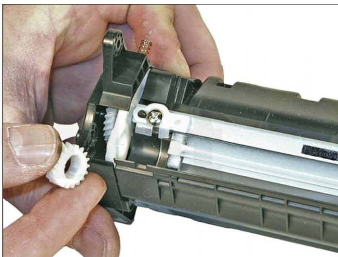
15. Снимите приводную шестерню магнитного вала и бушинг, если он конечно не закреплен жестко.
