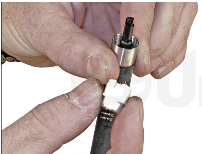
16. Замена оболочки магнитного ролика довольно легкая задача. Надавите на магнитный сердечник и пластиковая втулка снимется.
