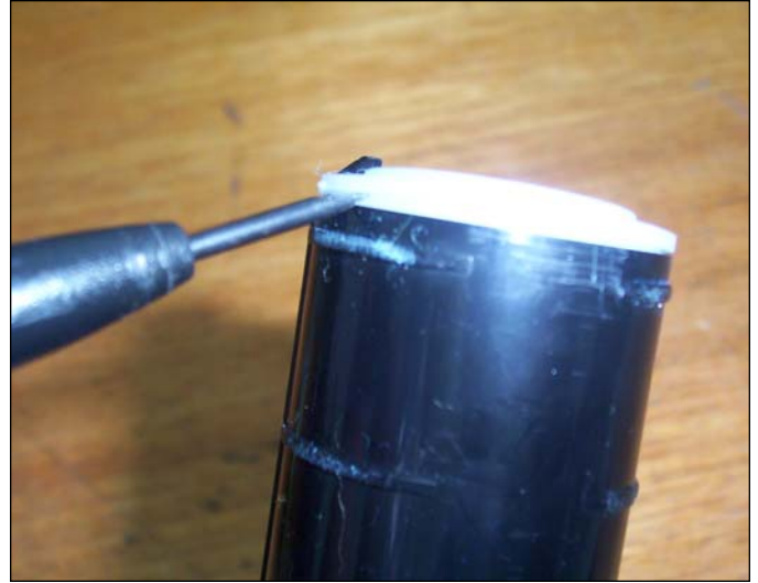
6. Remove the carrier fill plug.
