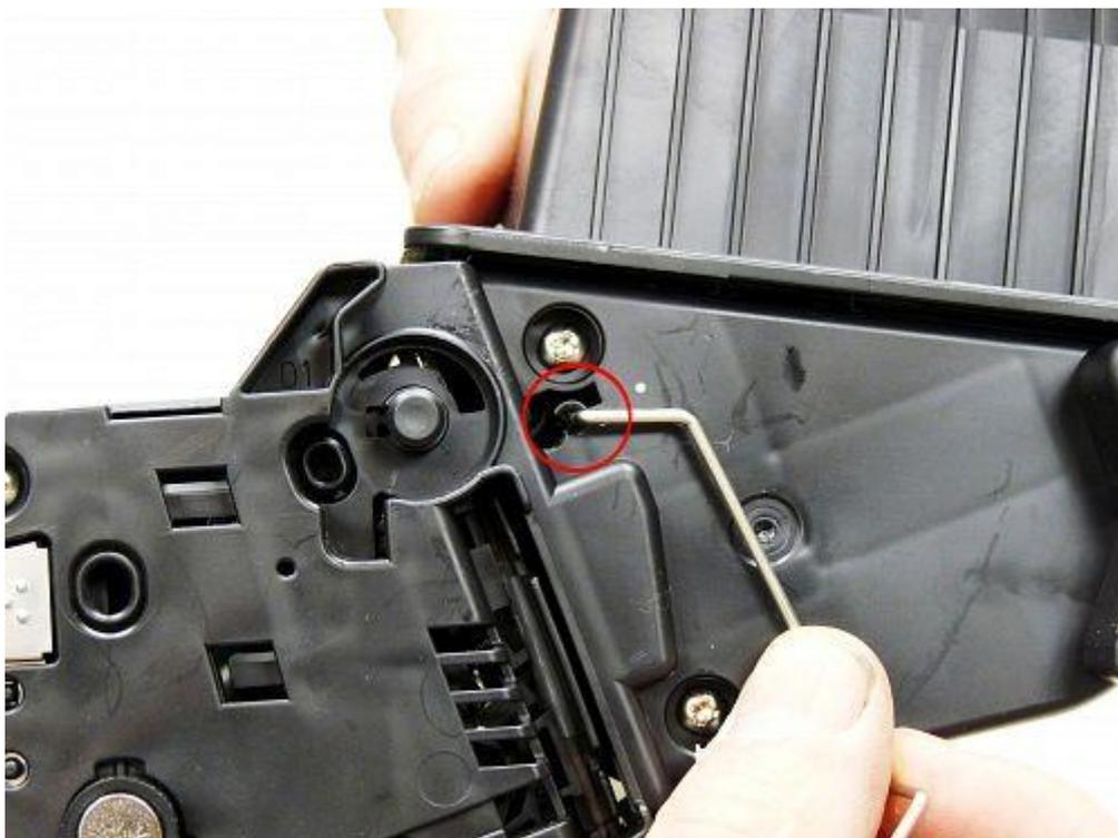
Снимите 5 винтов с левой торцевой крышки
