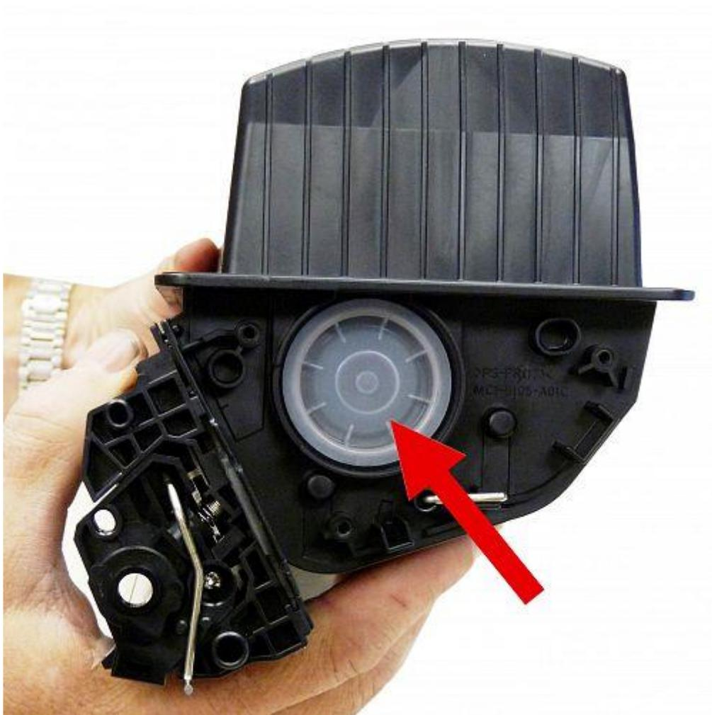
Следим, чтобы магнитные ловушки и уплотнитель были чистыми.
