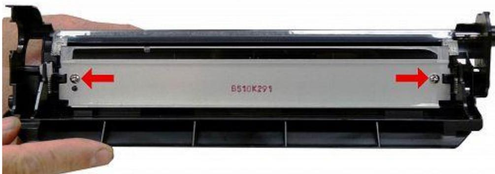
Обратите внимание, что бы на лезвии очистки (ракель) не было липкого герметика. Под лезвием есть только обычные пенные и войлочные уплотнения. Снимите лезвие очистки с
