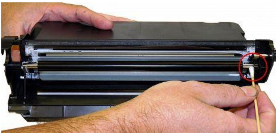
Установите фотобарабан, узел втулки барабана и винт. Убедитесь, что шестерни из узла втулки совпадают с ведущей шестерней на бункере.
