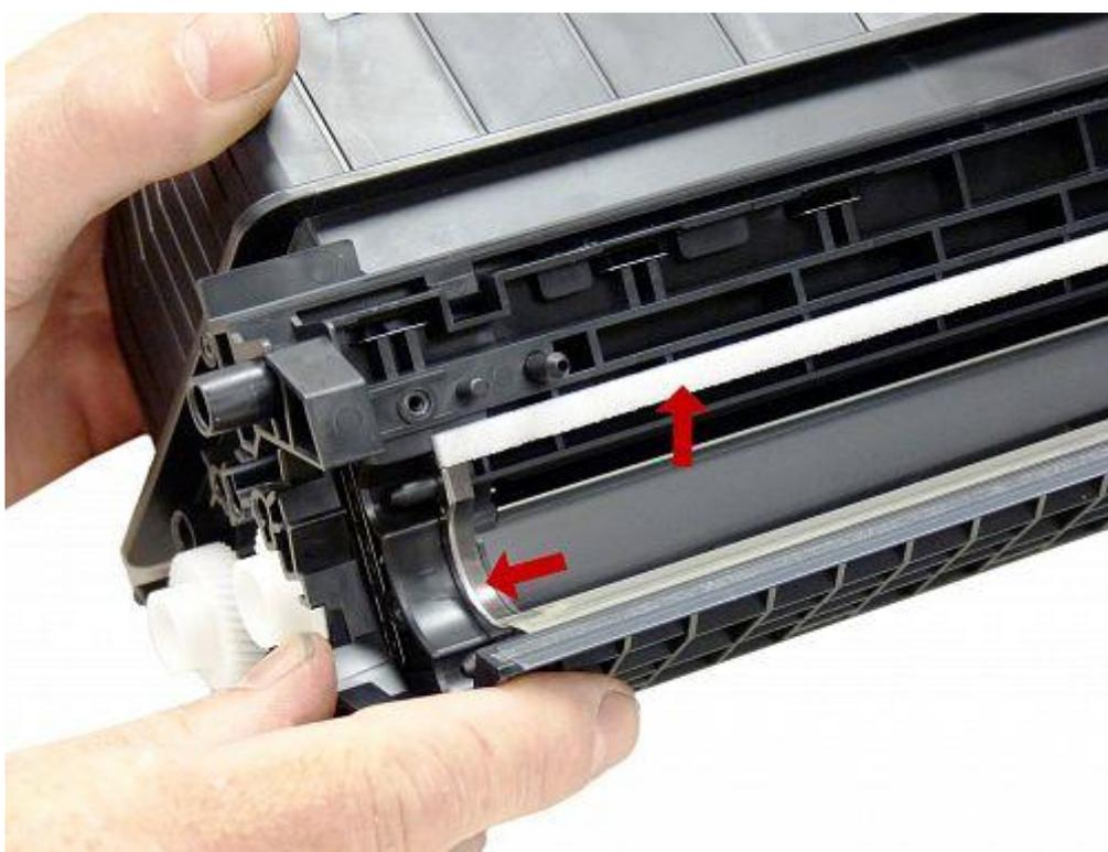
Устанавливаем и фиксируем дозирующее лезвие
