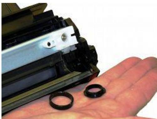
Приподнимаем прозрачные пленочные уловители тонера, откручиваем два винта и снимаем дозирующее лезвие.
