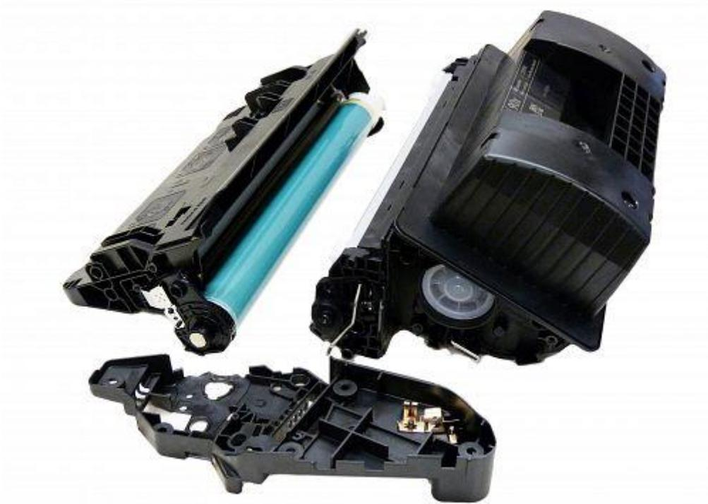
Снимите пластиковую втулку, и зубчатую шестеренку в сборе открутив винт
