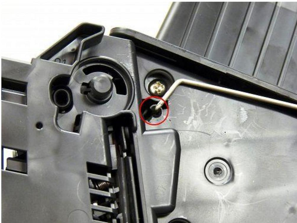
Устанавливаем пружину в правильное положение и ставим крепление шторки на место
