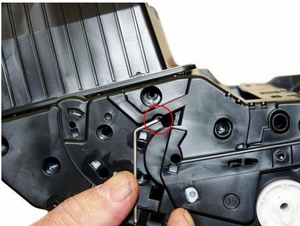
На противоположной стороне картриджа аккуратно снимите пластиковую ручку шторы фотобарабана. ВНИМАНИЕ пружина может потеряться, позаботьтесь, чтобы не потерять ее.
