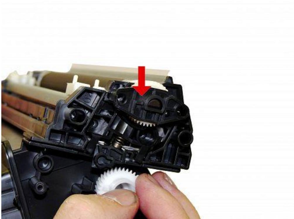
Там же откручиваем два винта и удаляем крепление магнитного вал. Следим, чтобы пружина не потерялась
