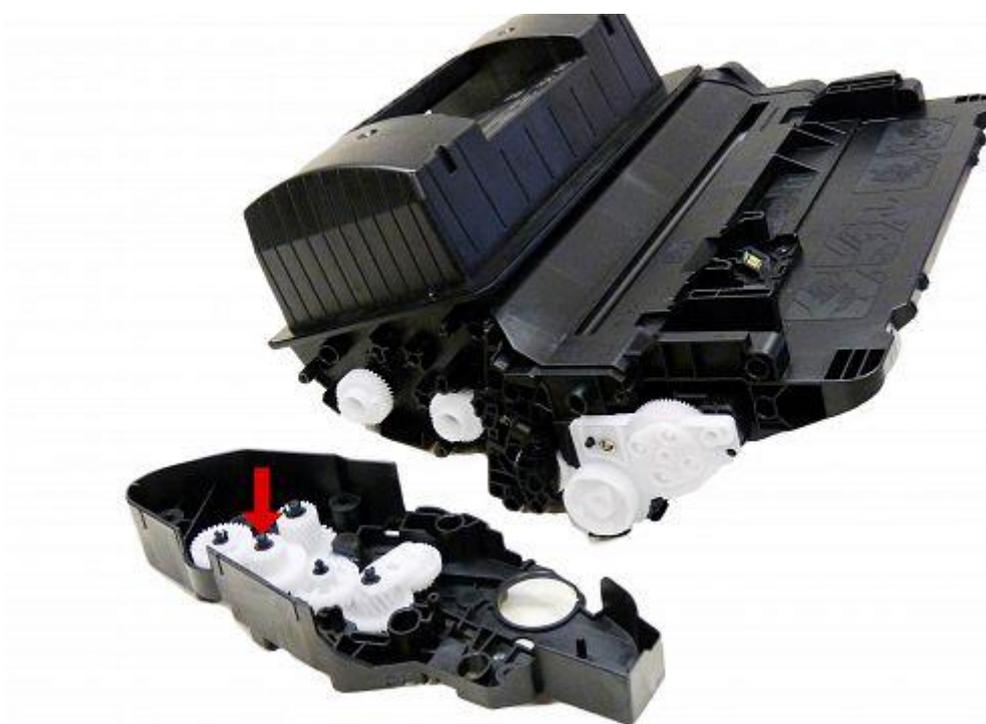
Снимите левую боковую крышку. Обе половинки легко распадаются. Будьте осторожны, чтобы не повредить барабанную или магнитную втулку.
