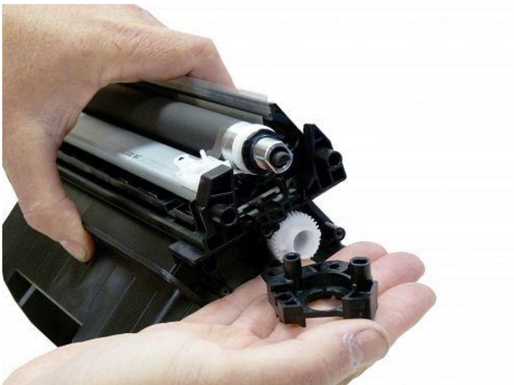
Снимаем магнитный вал, после чего моем его от остатком тонера. Не потеряйте втулки магнитного вала.
