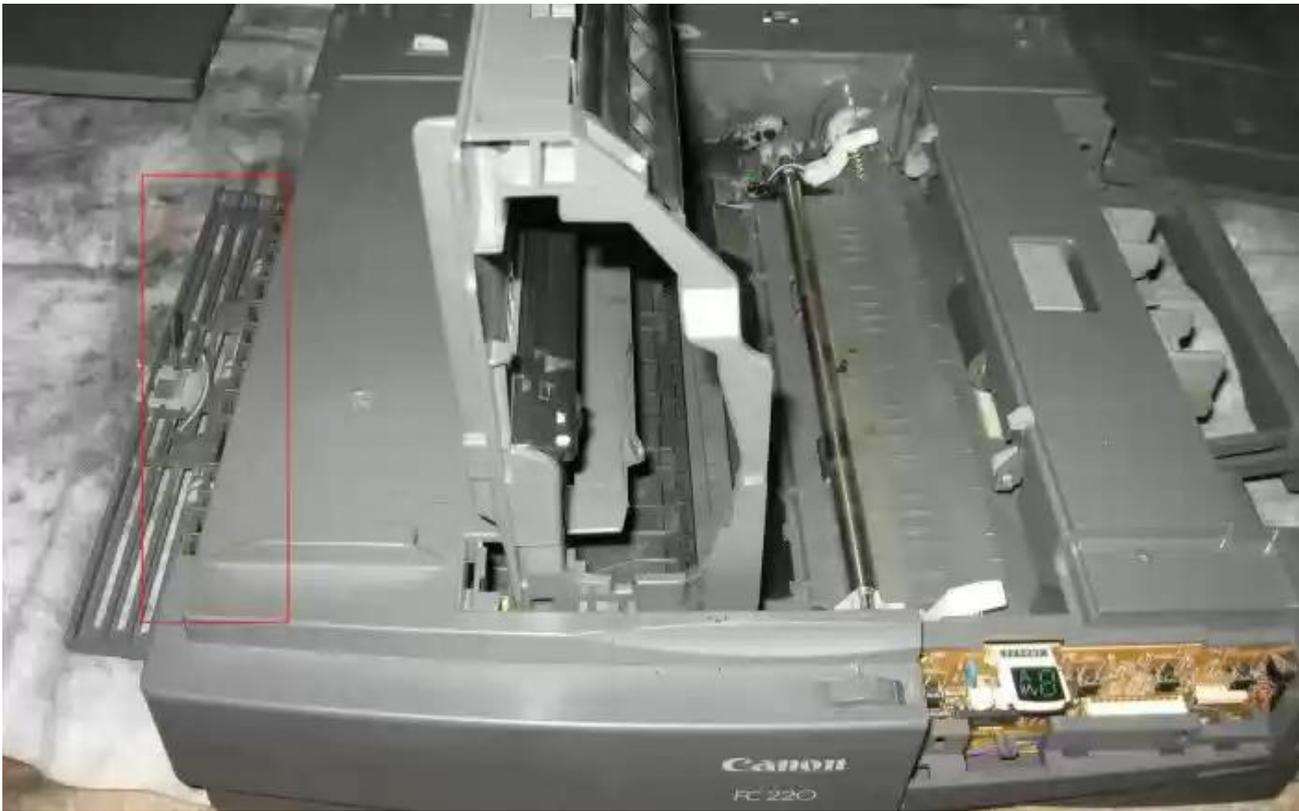
Открываем заднюю крышку и дверцу картриджа и с помощью плоской отвертки поддеваем верхнюю часть корпуса по периметру и снимаем ее.
