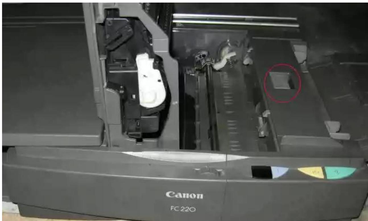
Отодвигаем стол влево и нажав на кнопку открываем крышку и вынимаем картридж.
