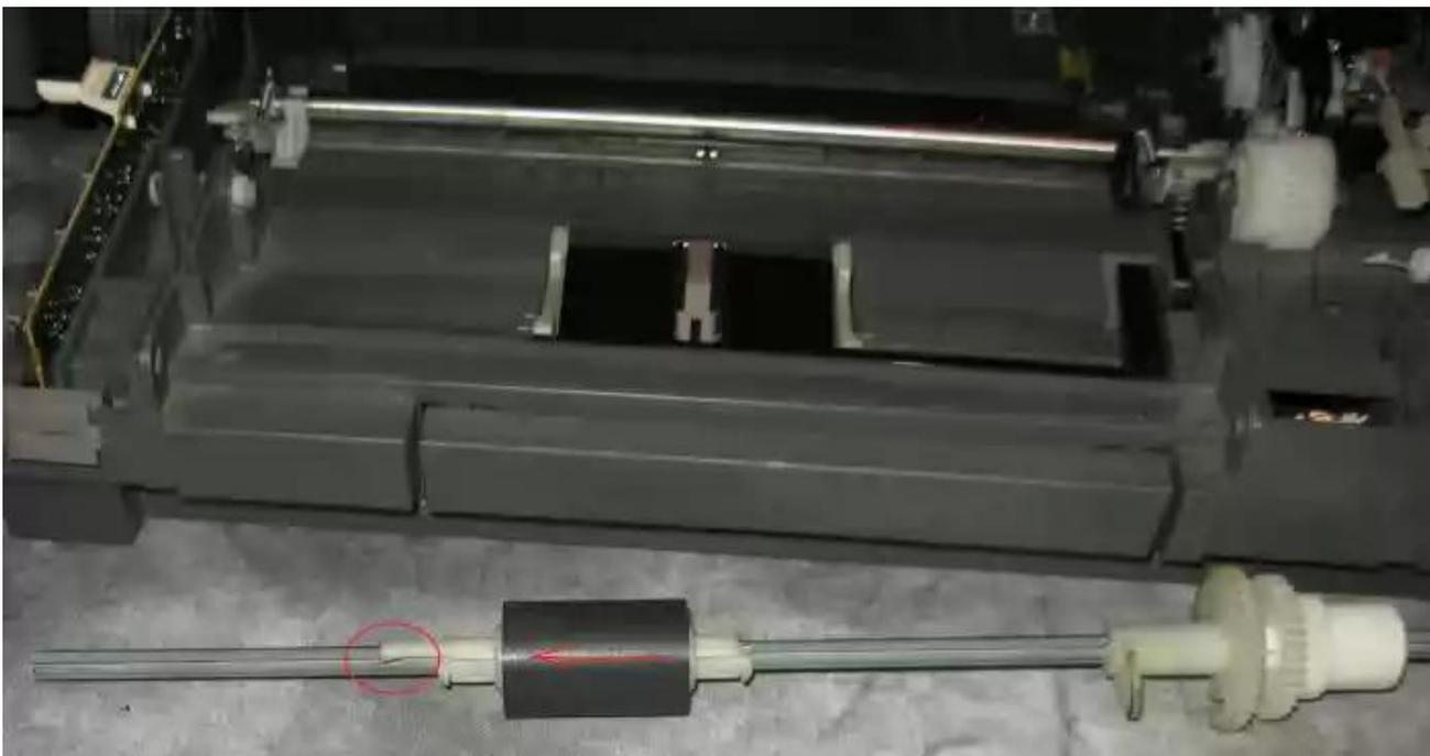
**Затем подцепляем защелку ролика подачи и снимаем его влево, на его место ставим новый и собираем аппарат. Когда будете ставить вал с роликом на место, сначала вставляете левый бушинг, потом правый.**
