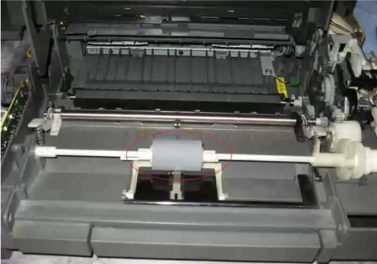
**Перед вами ролик захвата, который мы собственно и хотим заменить. Справа от ролика вы видите механизм, который приводит его во вращение. Его нужно разобрать.**
