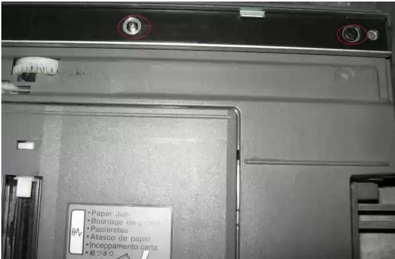
Откручиваем винты держащие рельс со стеклом. Снимаем стекло.
