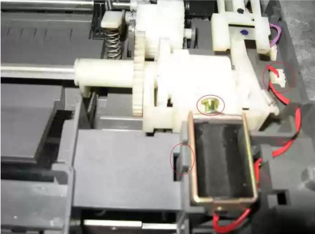
**Вынимаем провода соленоида из разъема, отводим в сторону защелку и снимаем соленоид.**
