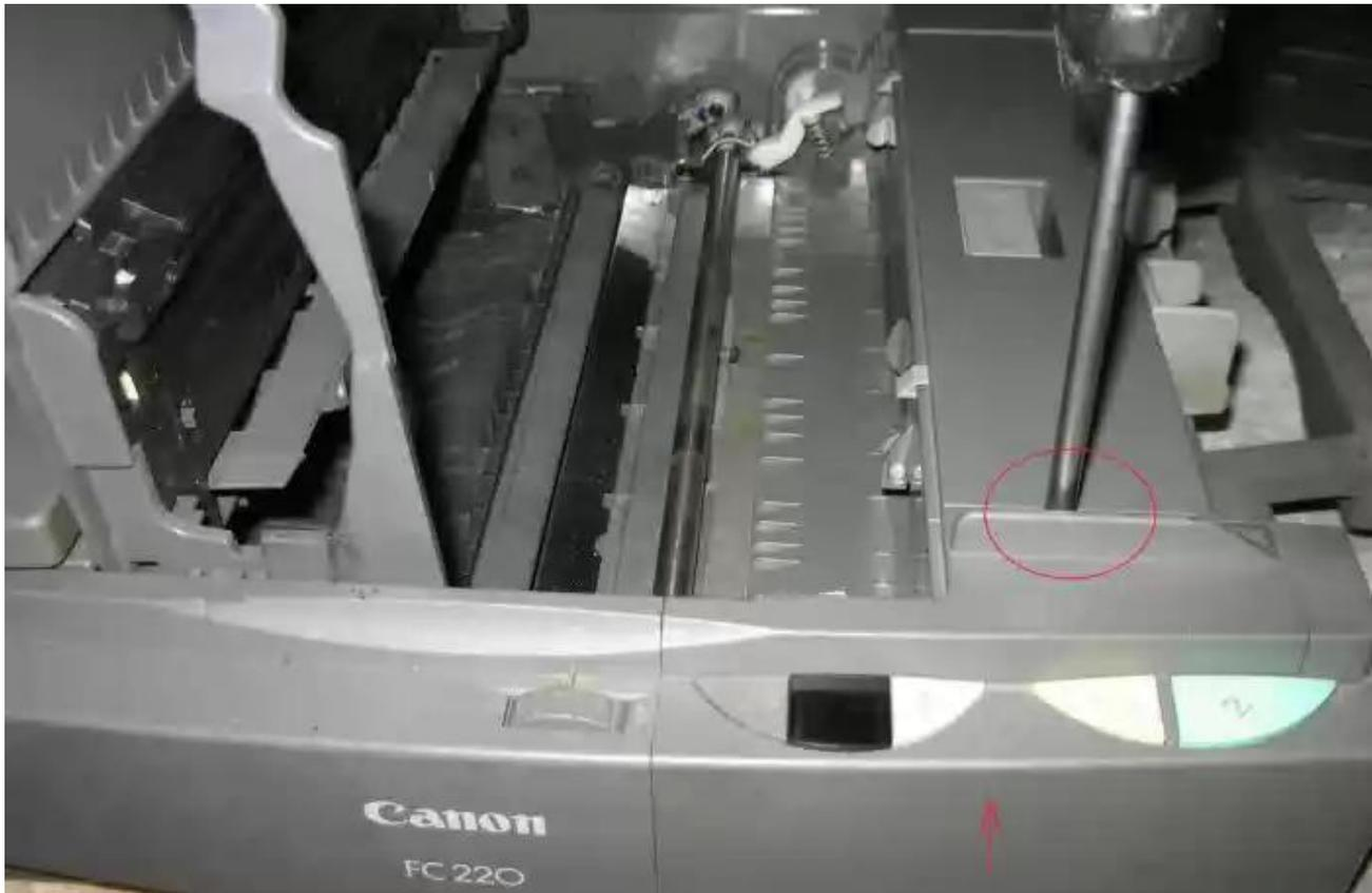
Откручиваем винт и снимаем панель управления.
